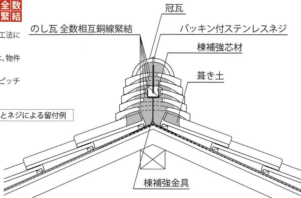
棟補強金具と緊結線による留付例
